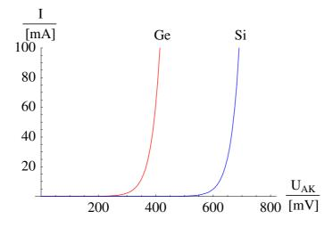
Dieses Schaubild wird auch bei Tietze/Schenk ([TS1980], Abb. 3.3, Seite 24) dargestellt. Dies ist *kein* Ohmsches Gesetz, da *keine Gerade* resultiert! Die rote Kurve gilt für eine Germanium-Diode, die blaue für eine Silizium-Diode.
